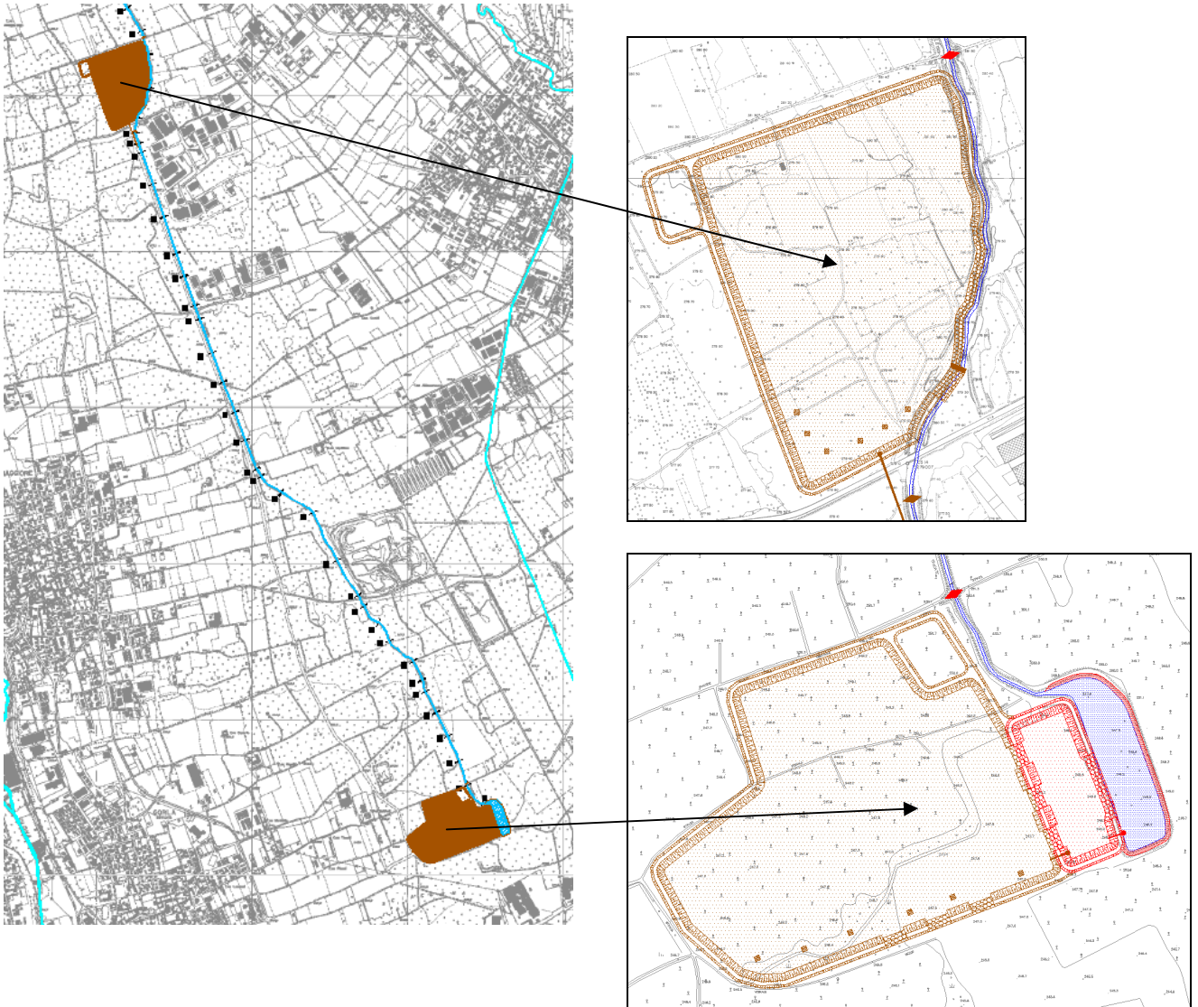
Figura 14 – vasche di laminazione – prevista (Tradate-a Nord) e realizzata (Gorla Minore-a Sud)
