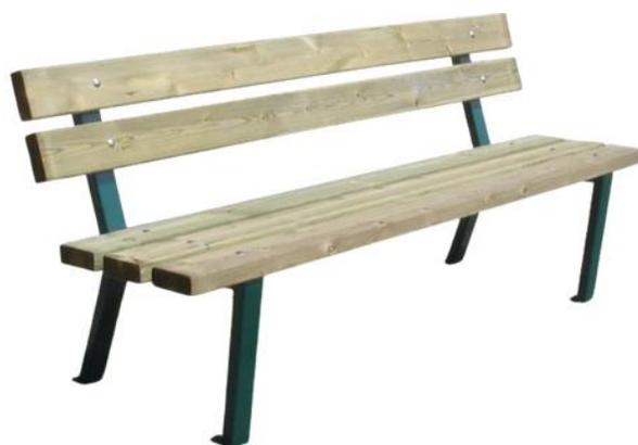
Panchina composta da n. 2 supporti in lamiera d'acciaio zincato sp. 30/10 opportunamente pressopiegata. Seduta e schienale composti da n. 5 doghe in legno di pino nordico impregnato in autoclave mediante sali atossici sez. mm. 110 x 45 x 1900. Supporti dotati di piastre per l'ancoraggio al suolo.
