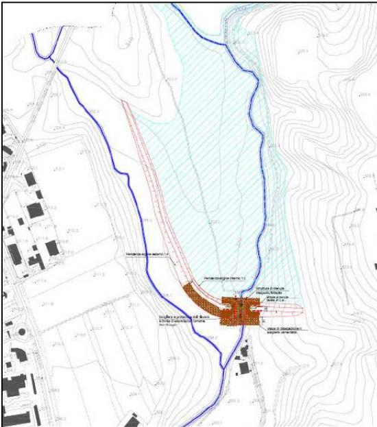
Figura 16 - Cassa di espansione in linea di monte (immagine sopra), Cassa di espansione in derivazione di valle (immagine sotto)
