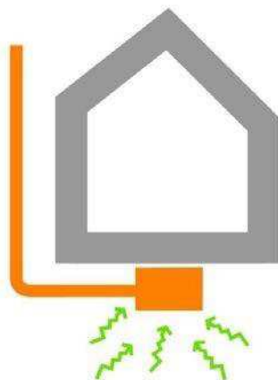
Figura 13: depressione del sottosuolo tramite pozzetto.
