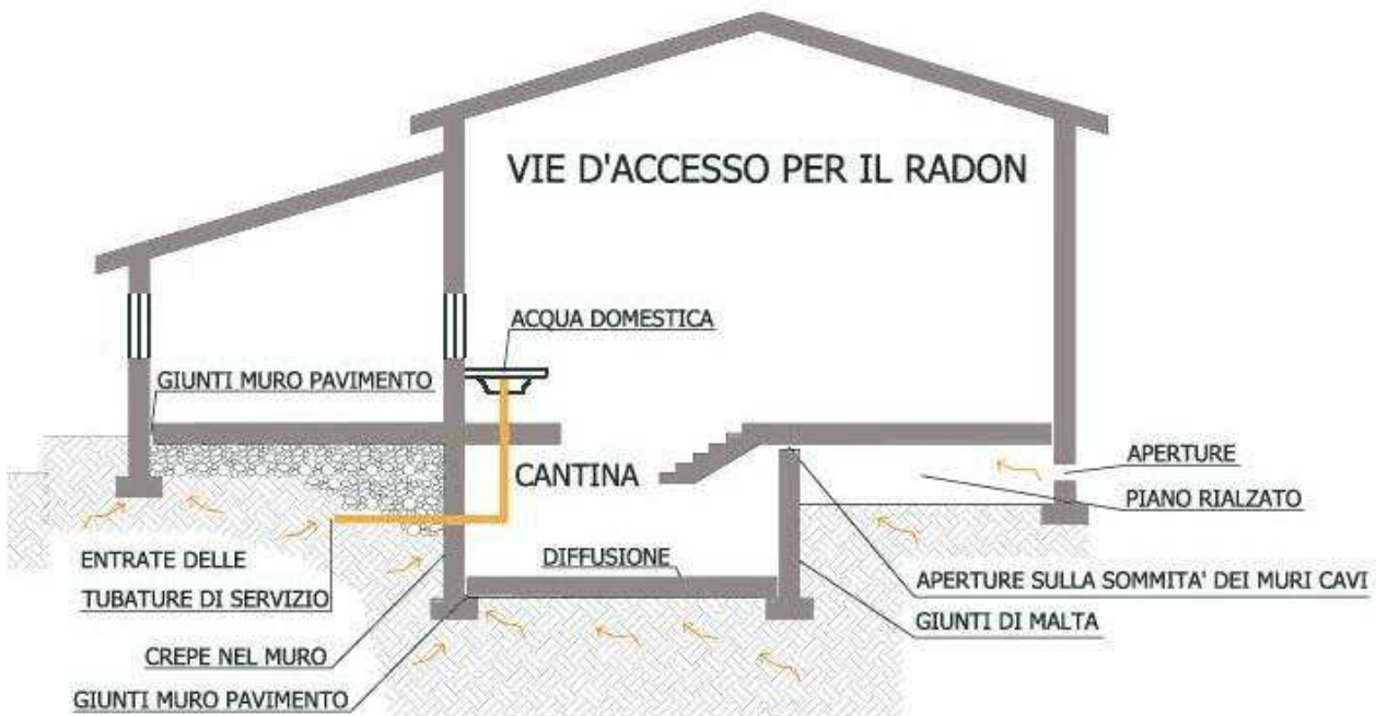
Figura 5: vie d'accesso per il radon
