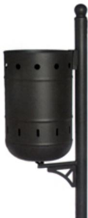
Cestino basculante litri 40 realizzato in lamiera d'acciaio zincata, nervata e calandrata con estremità pressopiegata per evitare parti taglienti. Sistema di chiusura a chiave. Palo di supporto in tubolare di acciaio con parte terminale sferica. Zincato a caldo e verniciato a polveri.
