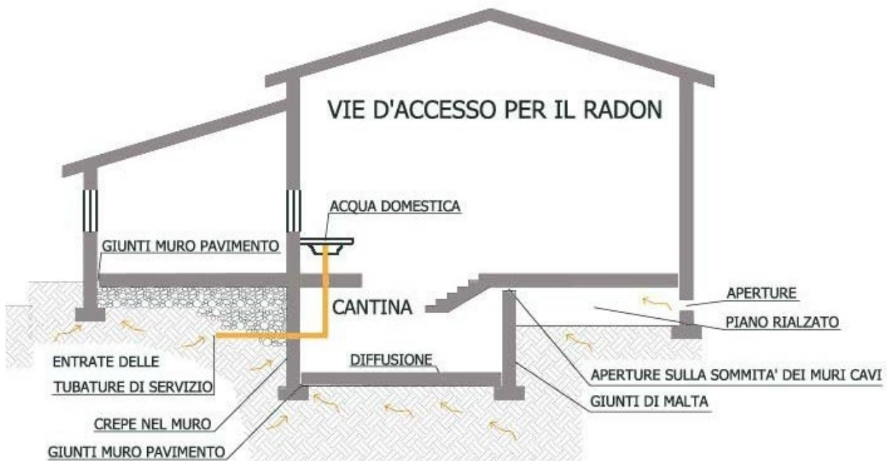
Figura 5: vie d'accesso per il radon
