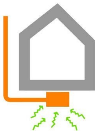
Figura 13: depressione del sottosuolo tramite pozzetto.
