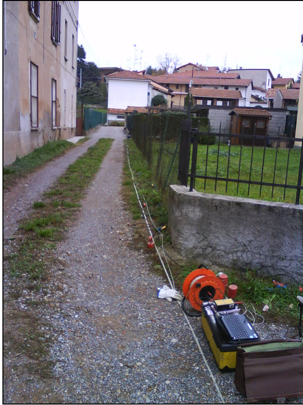
Fig. 3 – Tracciato indagine sismica M.A.S.W.
