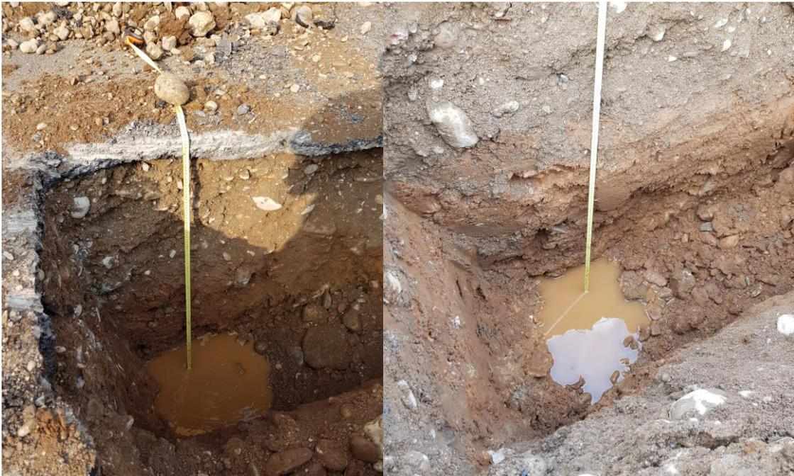
Foto 17 e 18: inizio prova infiltrometrica in scavo 1 (a sinistra ) e scavo 2 (a destra)
