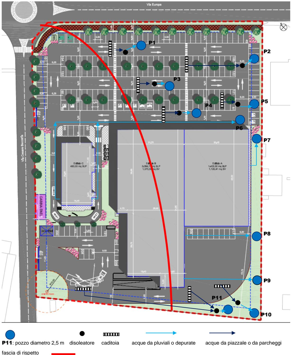
Figura 16: possibile disposizione dei pozzi perdenti e collegamenti per il recupero delle acque meteoriche
