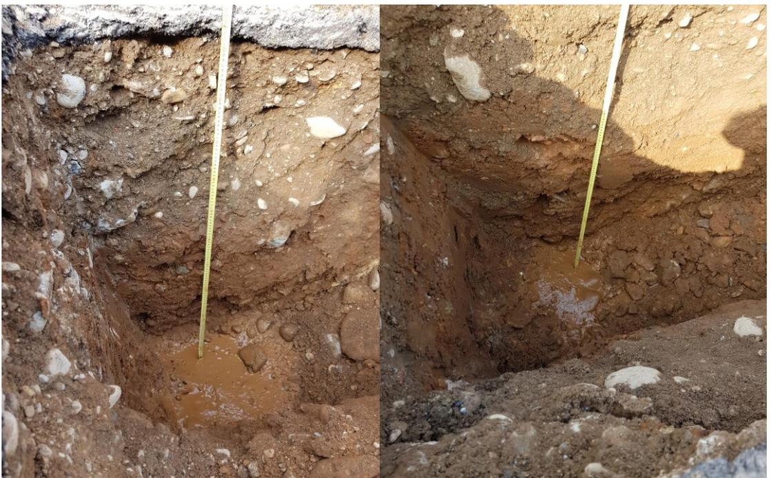
Foto 19 e 20: fine prova infiltrometrica in scavo 1 (a sinistra ) e scavo 2 (a destra)
