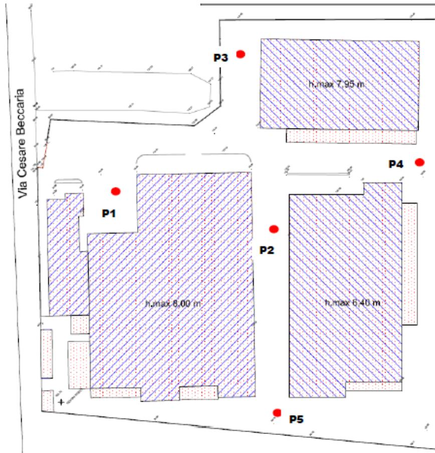
Figura 10: planimetria stato di fatto con ubicazione punti di prova penetrometrica (scala 1:;1000)
