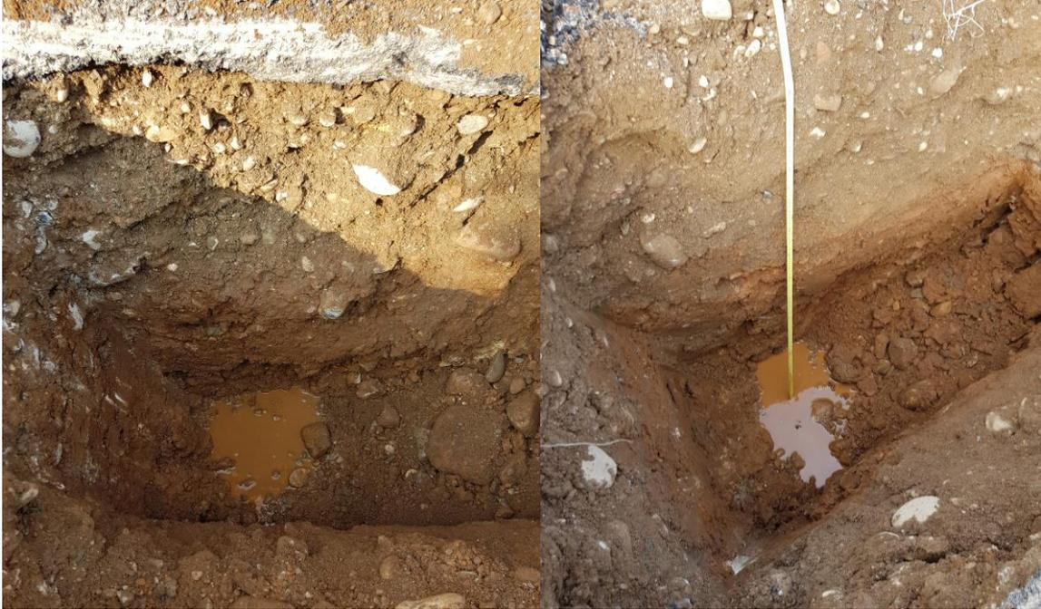
Foto 15 e 16: assorbimento acqua per raggiungimento saturazione in scavo 1 (a sinistra) e scavo 2 (a destra)
