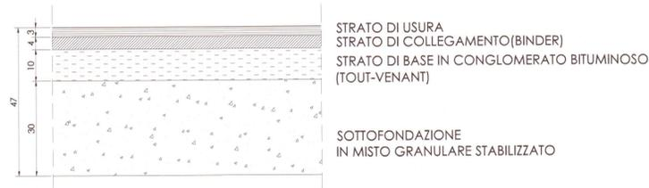
PARTICOLARE PAVIMENTAZIONE (STRADALE RIDOTTA)
