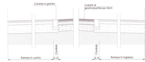
PARTICOLARE PAVIMENTAZIONE (STRADALE COMPLETA)
