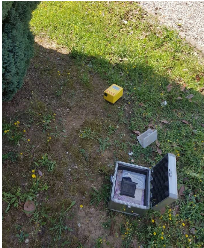
Foto 3: posizionamento strumentazione HVSR (Tromino)
