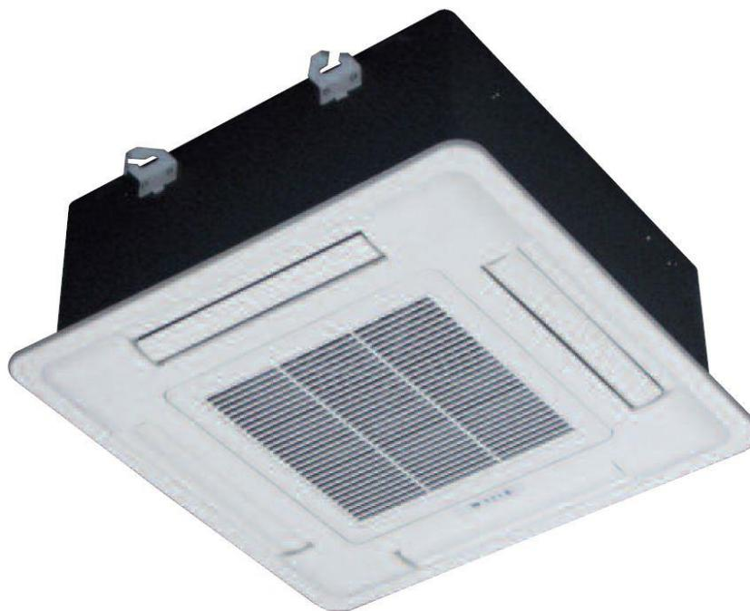
Le cassette si caratterizzano per la struttura in acciaio zincato coibentato con materassino in polietilene autoestinguente a cellule chiuse e spessore adeguato per limitare al minimo la dispersione termica e l'emissione acustica. Il pannello frontale è dotato di griglia e filtro incorporato alle cassette. La griglia di mandata aria è in ABS, mentre i deflettori aria sono orientabili manualmente ed indipendenti per la direzionabilità verticale dell'aria a due, tre e quattro vie.
