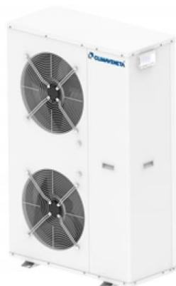
Unità da esterno per la produzione di acqua refrigerata/riscaldata con compressori ermetici rotativi azionati da motori a velocità variabile (Inverter Driven) in configurazione mono-circuito, con utilizzo di refrigerante R410A, batteria di scambio lato aria con tubi in rame ed alette in alluminio, scambiatore lato acqua a piastre saldo brasate e valvola di espansione elettronica di serie.
