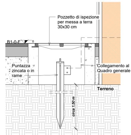
Sezione AA - Dettaglio Messa a terra
