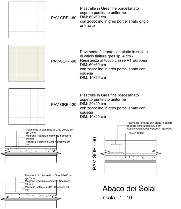
**N.B. nel pavimento del locale bagno prevedere impermeabilizzazione aggiuntiva sopra il massetto con miscela cementizia bicomponente.**
